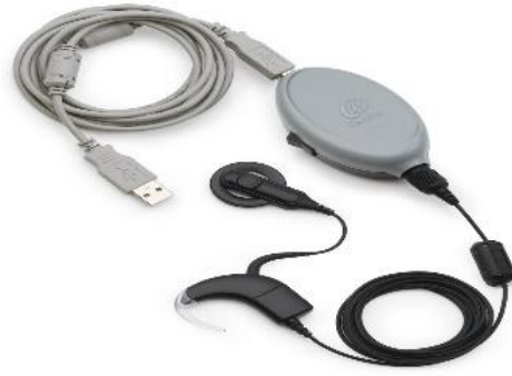
Şekil 2.6: Konuşma işlemcisinin programlama kablosuyla bilgisayara bağlanmış görüntüsü
