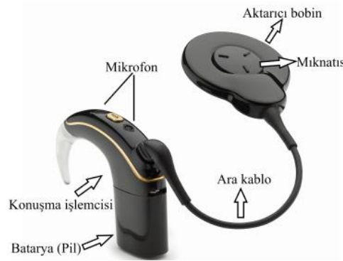
Şekil 2.1: Koklear implantın dış parçası
