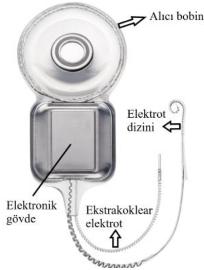
Şekil 2.2: Koklear implantın iç parçası
