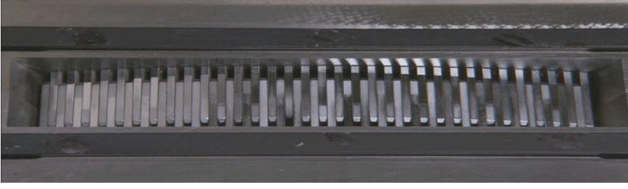
Şekil 2.9: Binary MLC (ikili çok yapraklı kolimatör) sistemi.
