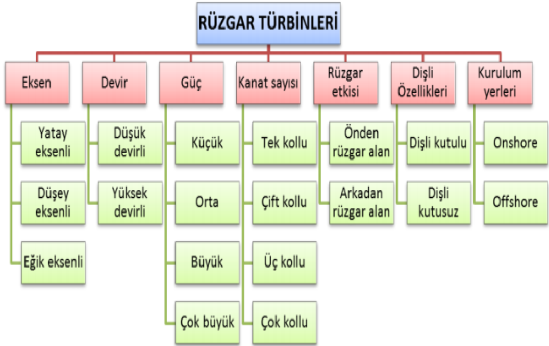
Şekil 4.1: Çalışma prensiplerine göre rüzgâr türbin sınıflandırması
