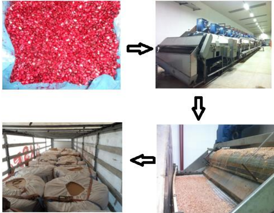
Şekil 5. Nar Çekirdeğinin Endüstriyel Boyutta Kurutulma Aşamaları
