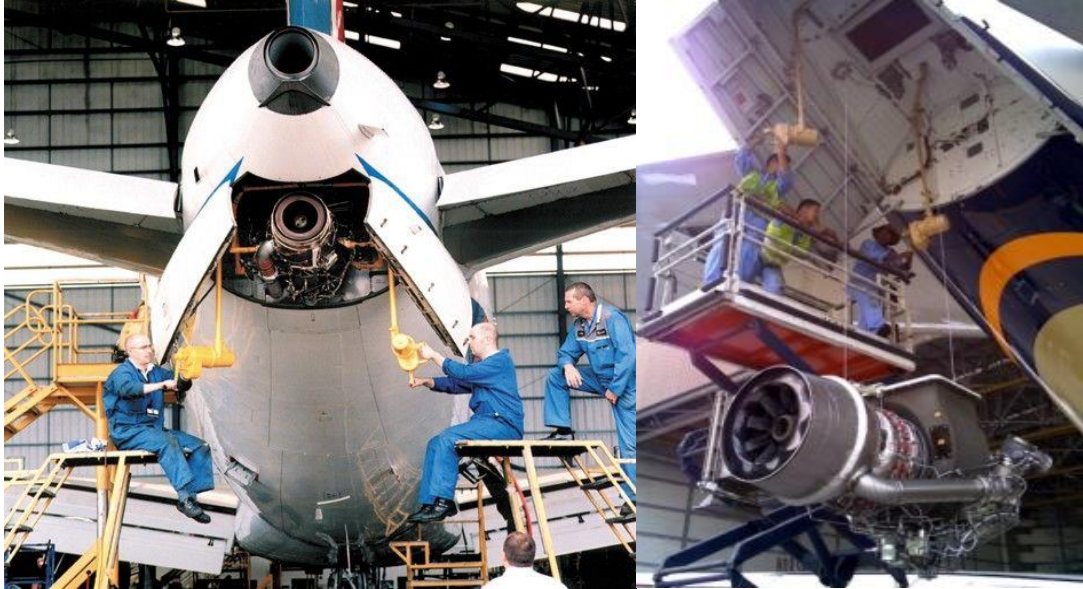
Şekil 46. Caraskal İle APU Söküm – Takımı Yapan Teknisyenler
