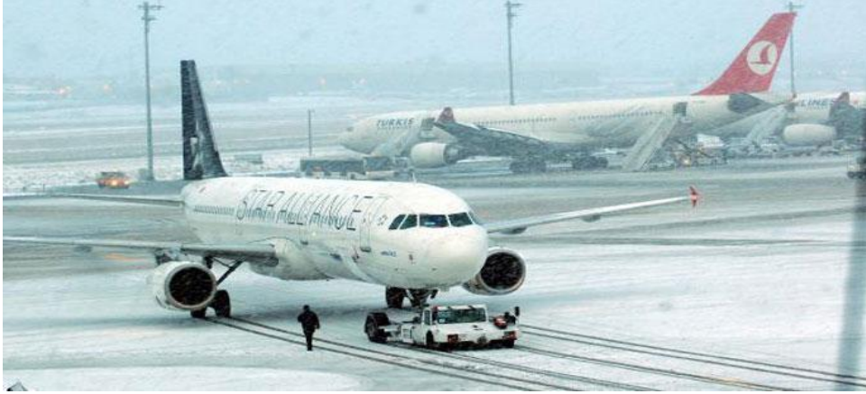
Şekil 65. Apron Sahasından Hangara Uçak Yanaştırma Teknisyenleri
