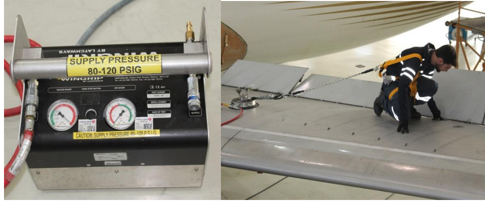
Şekil 34. Çapalara Giden Havanın Basıncını Ayarlayan Wingrip Regülatörü
