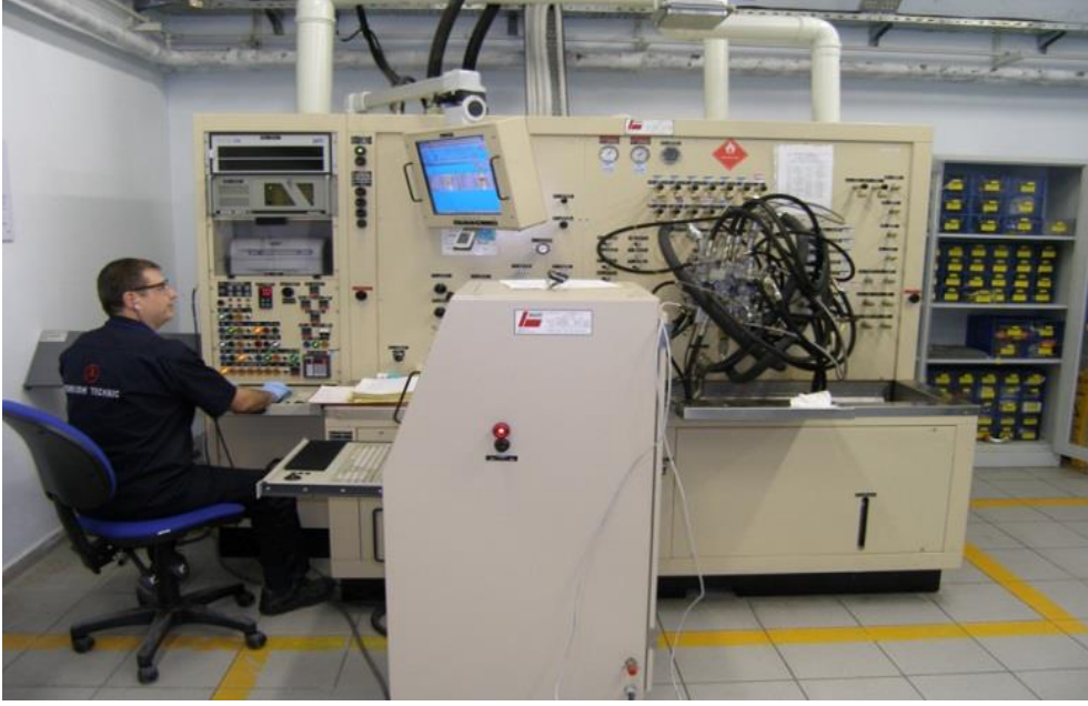
Şekil 24. Yakıt Boruları Test Ünitesi
