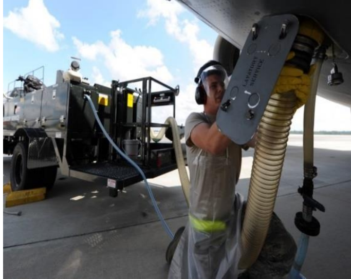
Şekil 42. Waste Tank Boşaltımı
