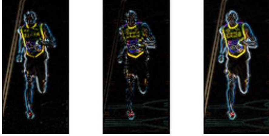
Şekil 9. Soldaki görüntü X gradyanının mutlak değerini ortadaki görüntü Y gradyanının mutlak değerini soldaki görüntü ise gradyanın büyüklüğünü göstermektedir.
