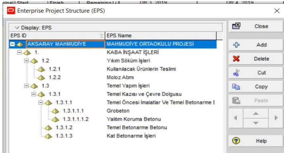
Şekil 7.18: P6'da iş kırılım yapısının detaylandırılması
