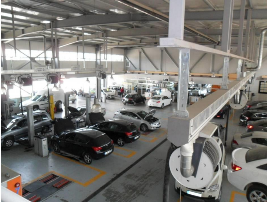
Şekil 2.4 :Servis içinde egzost hortumları
