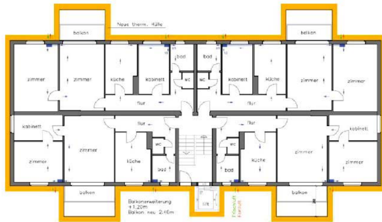
Şekil 1.5: Yenilenmiş binanın örnek kat planı – yeni termal bina kabuğu, entegre balkon ve yeni asansör gösterme [Url-2]
