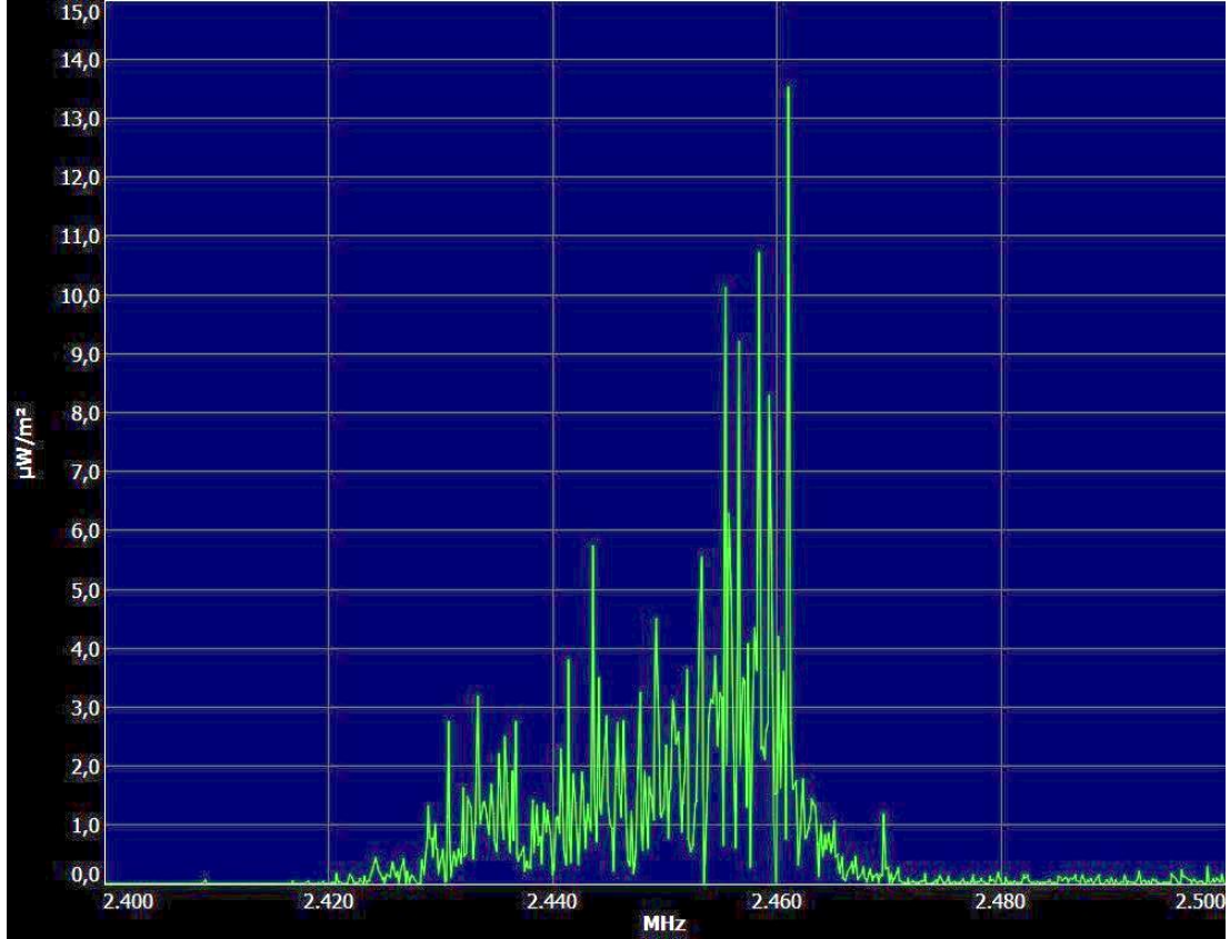
Şekil 6.2.1 : 1 cihaz modemle veri transferi hâlindeyken, modeme 4 metre uzaklıkta ölçülen Güç Yoğunluğu’nun, Wi-Fi frekanslarındaki dağılımı
