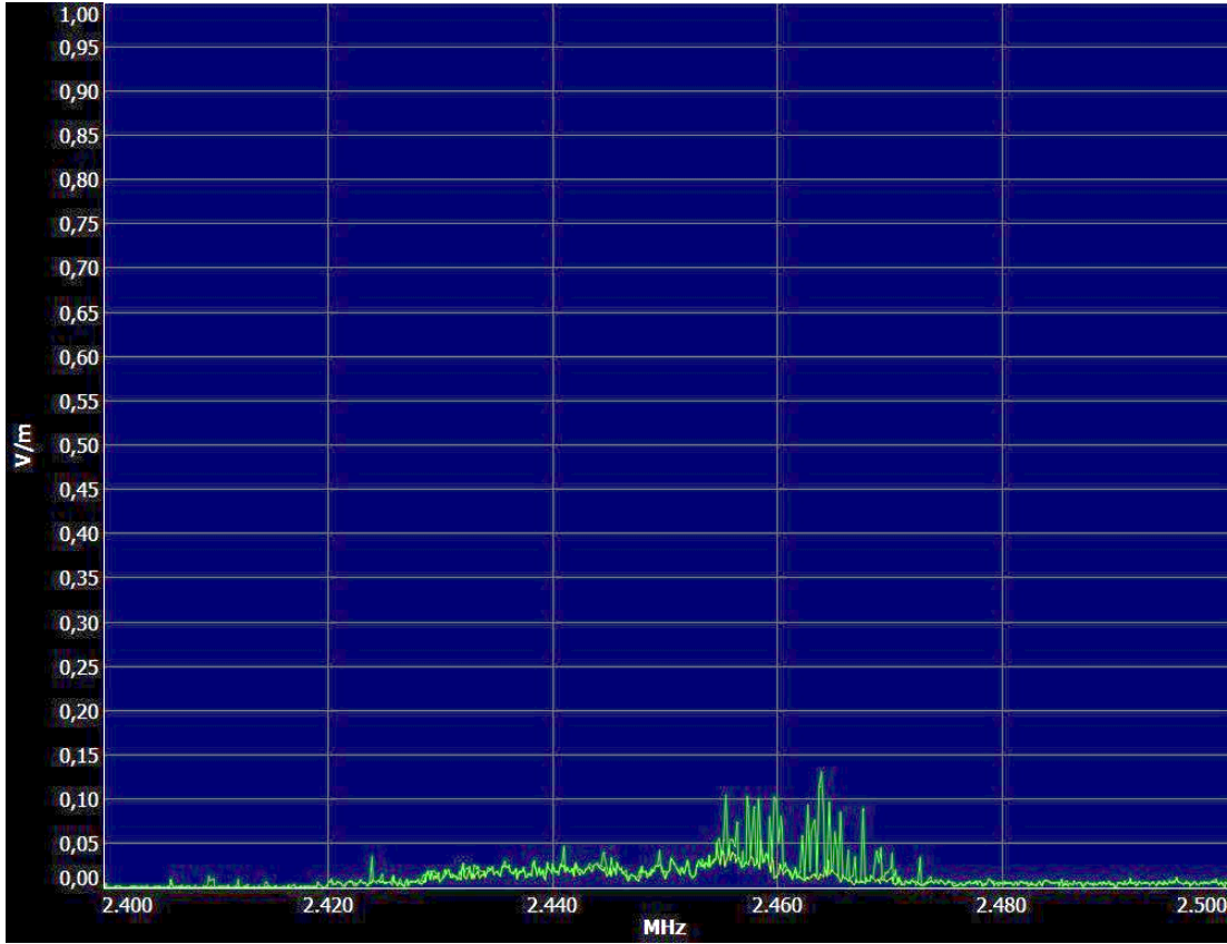
Şekil 6.2.2 : 1 cihaz modemle veri transferi hâlindeyken, modeme 4 metre uzaklıkta ölçülen Elektrik Alan'ın, Wi-Fi frekanslarındaki dağılımı
