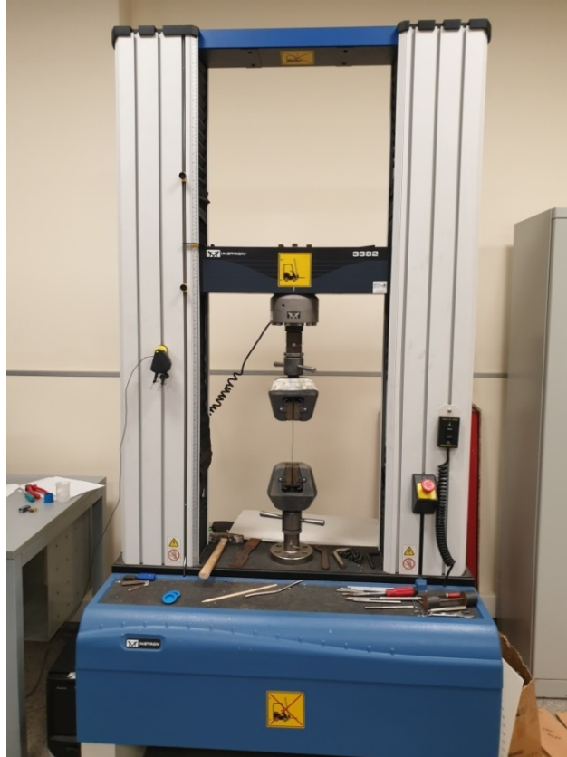
Şekil 5.6: Instron 3382 çekme testi cihazı
