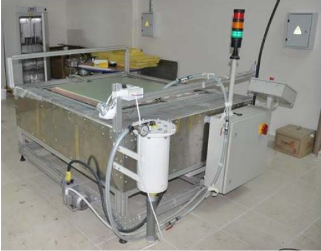
Şekil 3.12: Vakum infüzyon yöntemi
