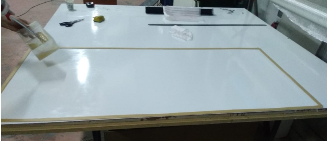
Şekil 4.1: Çerçevenin oluşturulması ve vakslama işlemi
