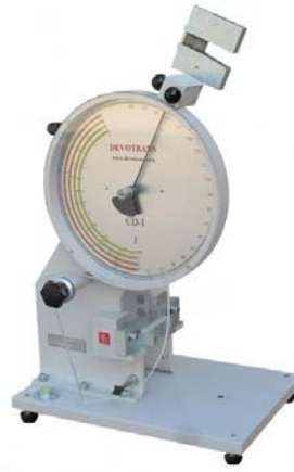
Şekil 5.15: Devotrans 1C darbe test cihazı
