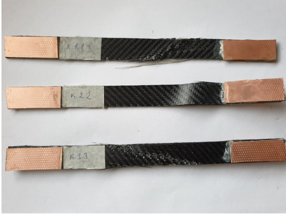
Şekil 5.10: Yüzey çatlaksız numunelerdeki deformasyon
