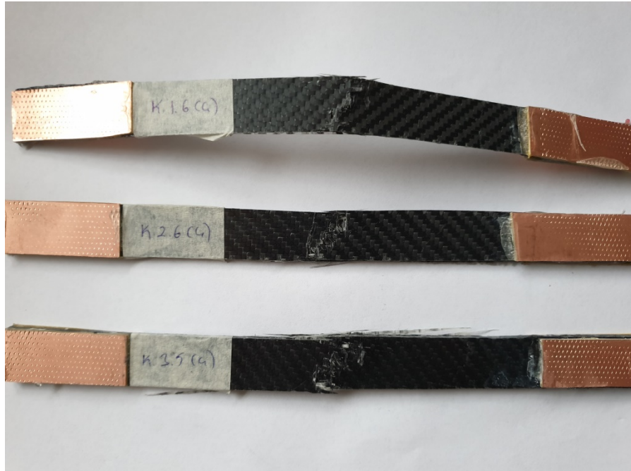
Şekil 5.11: Yüzey çatlaklı numunelerdeki deformasyon
