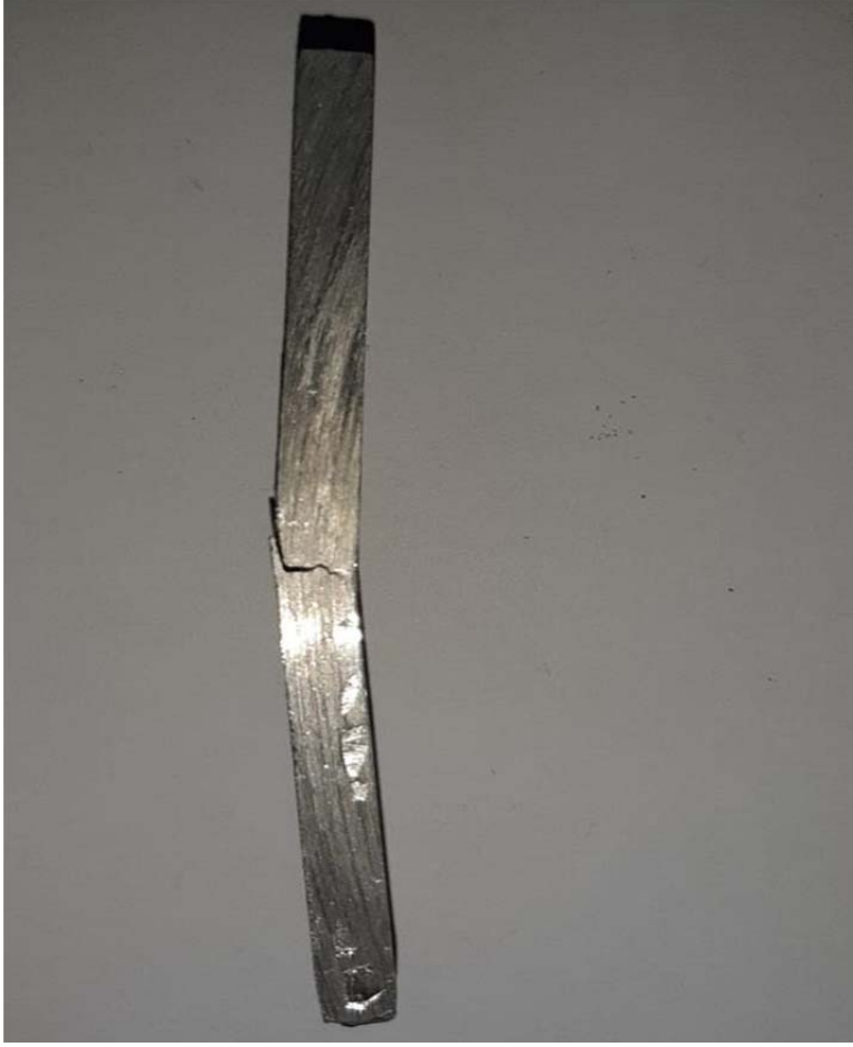
Şekil 3.14: Eğme testi sonrası çatlama görünümü
