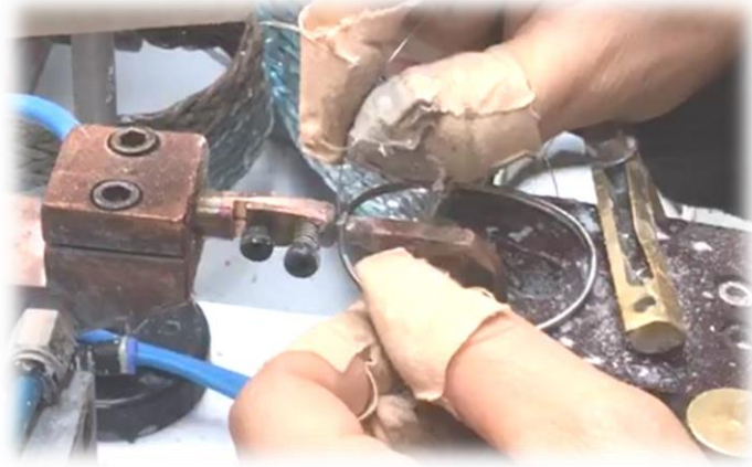
Şekil 4-2: Boru Kaynak İşlemi
