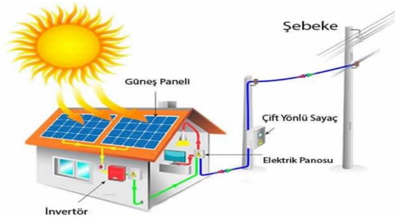
Şekil 4.1: Şebekeye Bağlı (On-Grid) Sistem [Url-1]
