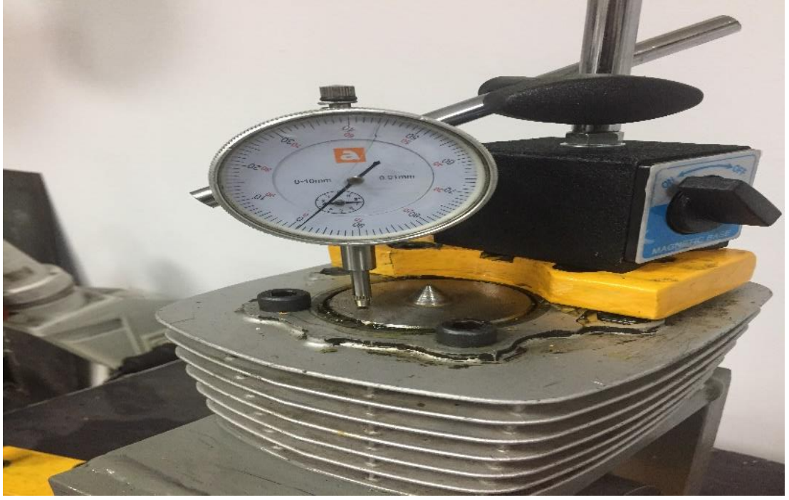
Şekil 3.10: Strok ayarının ölçümü
