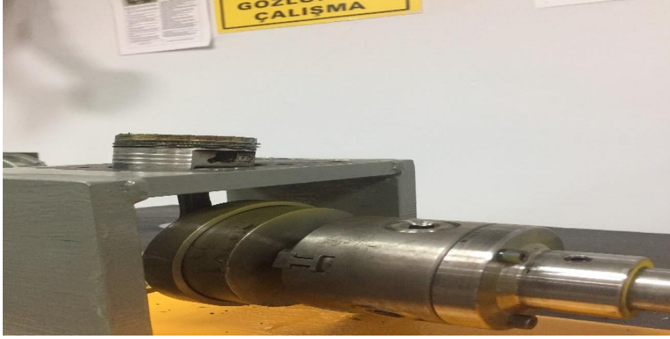
Şekil 3.7: Biyel kolu-Piston bağlantısı
