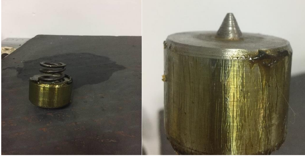
Şekil 3.9: Numuneye kuvvet uygulayan kapak ve Yay
