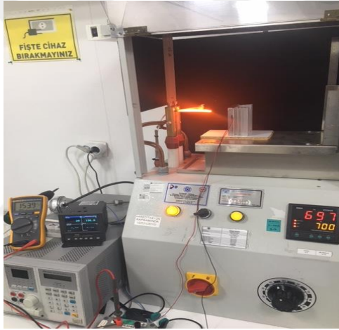
Şekil 7.8 : 697 °C ve 748 °C Kaynak Sıcaklığında Hücre Sıcaklığı Ve Gerilim Değerleri
