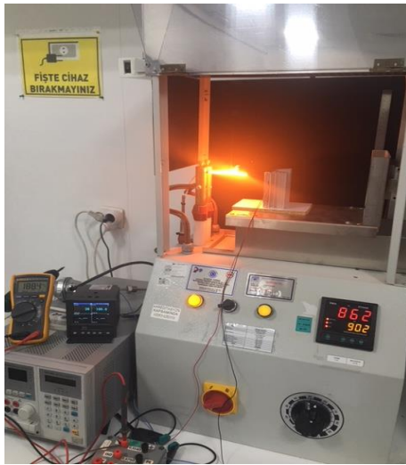
Şekil 7.9 : 862 °C ve 898 °C Kaynak Sıcaklığında Hücre Sıcaklığı Ve Gerilim Değerleri
