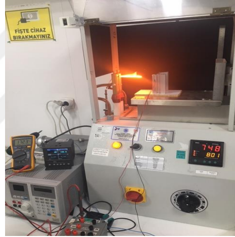
Şekil 7.8 : 697 °C ve 748 °C Kaynak Sıcaklığında Hücre Sıcaklığı Ve Gerilim Değerleri
