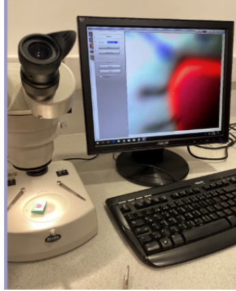
Şekil 25 İnternal ve Marjinal Aralığın Mikroskop Altında Ölçümü
