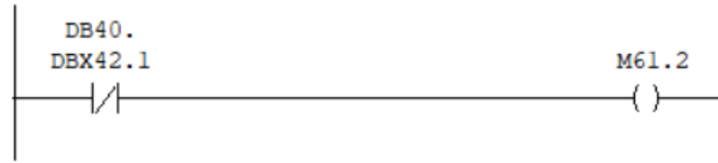
Şekil 35 Network 6 Normalde Açık Kontak – Network 8 Normalde Kapalı Kontak
