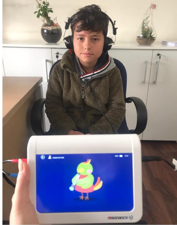
Şekil 7. Resonance R17A İnteraktif Oyun Odyometri Uygulaması
