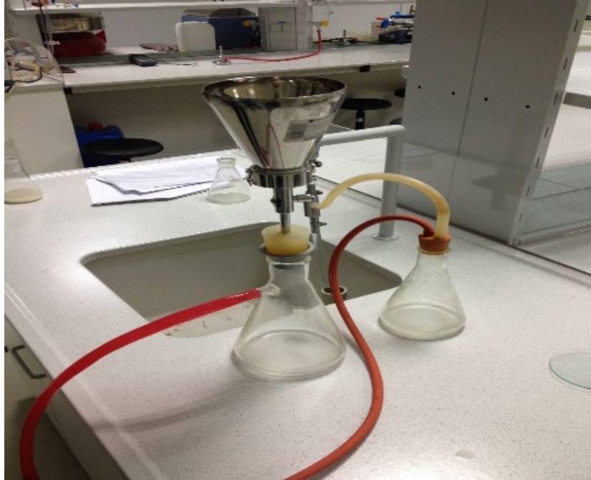
Şekil 3.1: Kilin Vakum Altında Süzülmesi.
