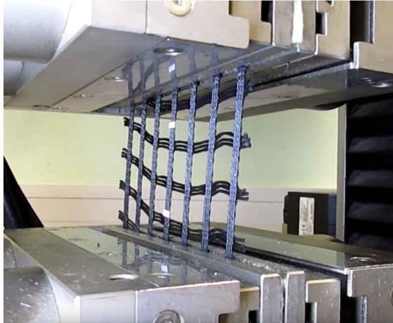
Şekil 5.4. Paralink 150, paralink 200 ve paralink 250 çekme deneyleri
