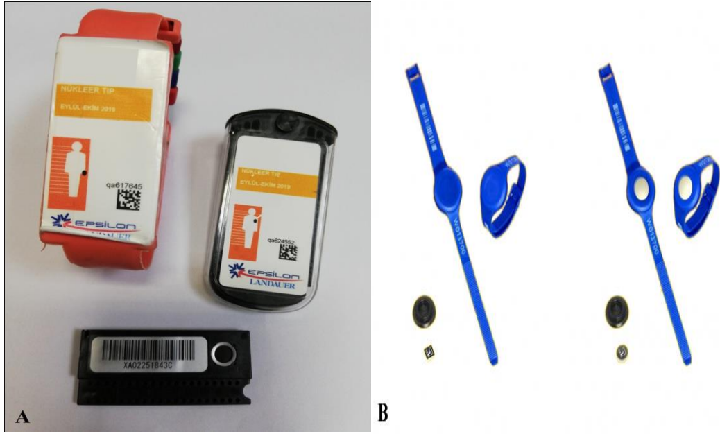
Şekil-29: (A) Hp(0.07) Bilek dozimetre ve Hp(10) vücut dozimetre. (B) Yüzük dozimetre(kaynak: http://www.epsilonlandauer.com.tr )
