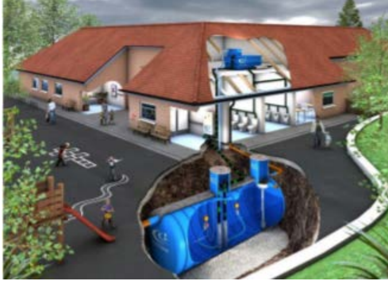
Şekil 26. Yağmur Suyu Hasadı İçin Örnek Yapı
