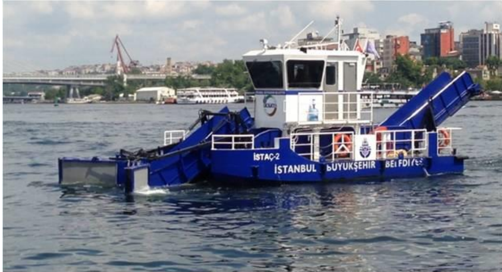
Şekil 4.4: Özel Donanımlı Deniz Yüzeyi Temizleme Aracı
