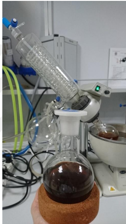
Şekil 3.3: Çözucunun vakumlu rotary evaporatörde uzaklaştırılması
