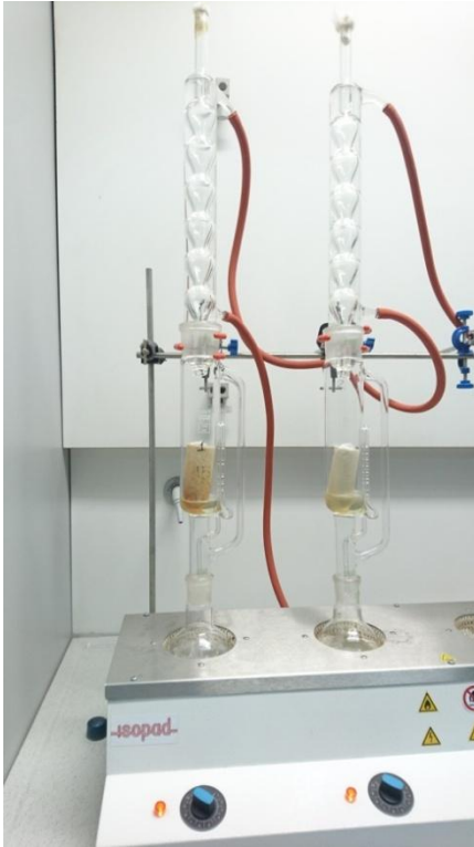
Şekil 3.2: Karanfil yağının ekstraksiyonu
