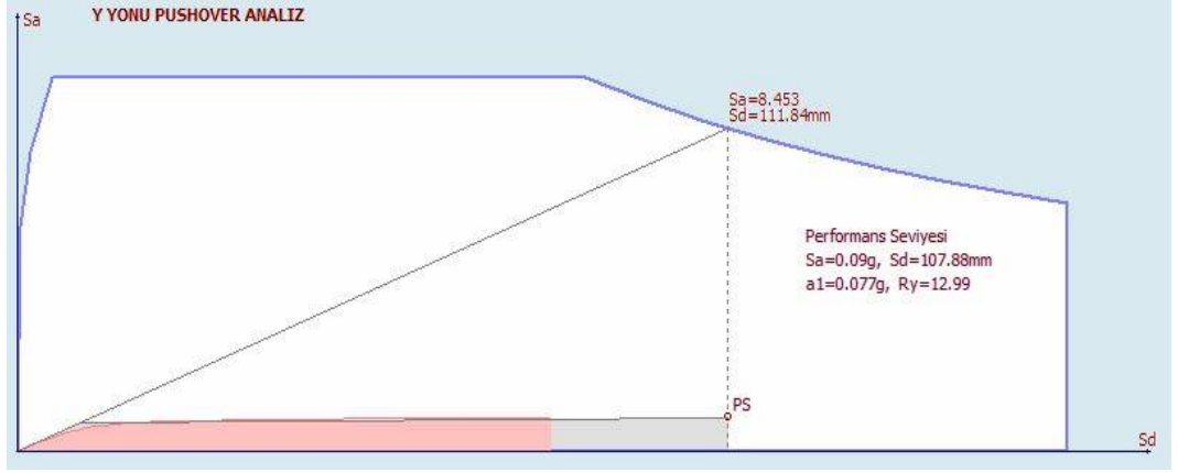
Şekil 4.53 : (6) Nolu binanın y yönü performans seviyesi (AMBY)
