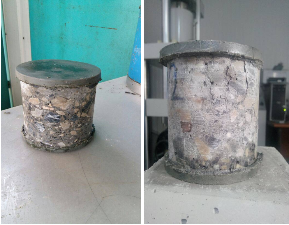
Şekil 3.17 : Başlıklama işlemi uygulanmış karot numune örnekleri
