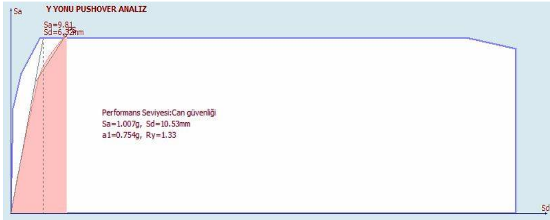
Şekil 4.66 : (1) Nolu binanın y yönü performans seviyesi (AEDYY)
