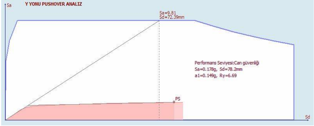
Şekil 4.68 : (2) Nolu binanın y yönü performans seviyesi (AEDYY)
