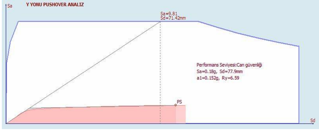
Şekil 4.80 : (2) Nolu binanın y yönü performans seviyesi (AMBY)
