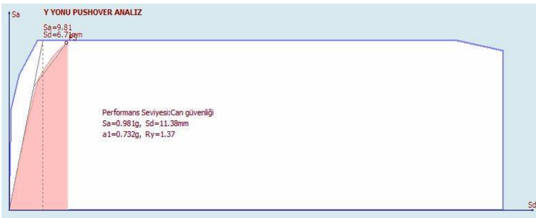
Şekil 4.78 : (1) Nolu binanın y yönü performans seviyesi (AMBY)
