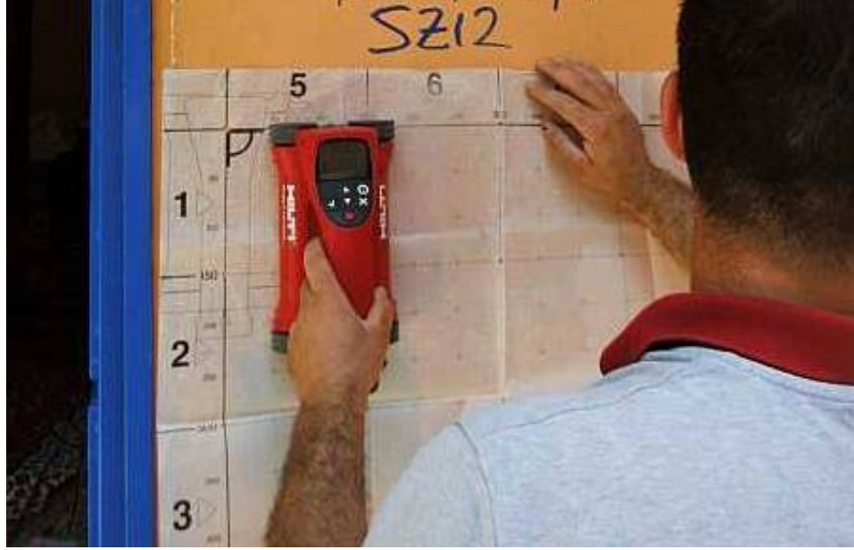
Şekil 3.30 : Tahribatsız yöntem (röntgen taraması) ile donatı tespiti işlemi
