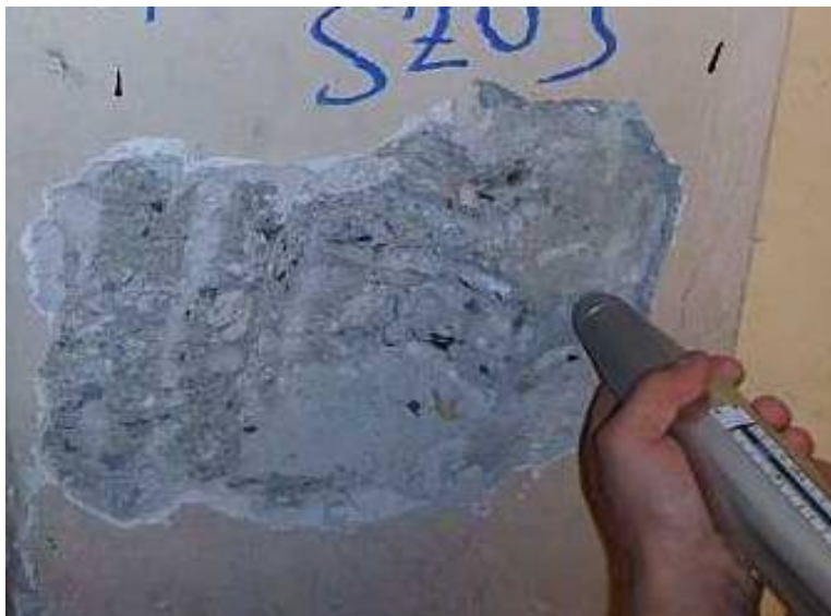
Şekil 3.5 : Test çekici uygulamaları
