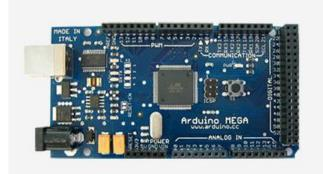
Figure 13 Arduino Mega.
