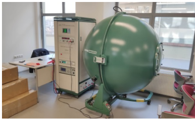
1.Kürenin ölçüm öncesi çalıştırılarak kendi sistemini hazırlaması
