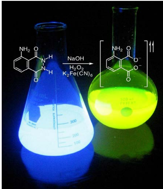
Şekil 3.15: Luminol testi. Büyük miktarda ışık üreten bir erlenmeyer şişesinde gerçekleştirilen kemo-ışıldayan bir reaksiyon.
