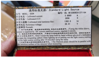
7. Standart ışık kaynağının kalibre edilmiş, standart değerleri
