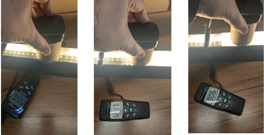
Şekil 8.22: Lüksmetre ile ölçüm
