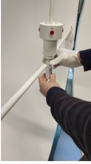
4. Standart ışık kaynağının ölçüm noktasına bağlanması
