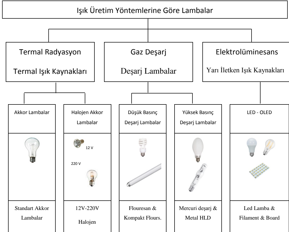
Şekil 8.9: Işık üretim yöntemlerine göre lambalar ve görselleri
