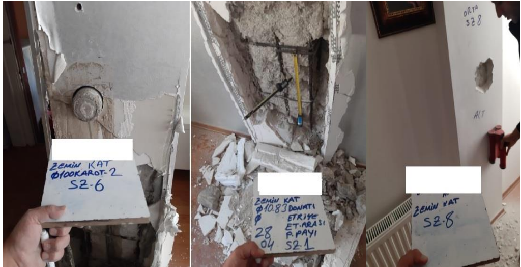
Şekil 24: Yapı-3 Karot alınması, sıyrma ve tarama ölçümü yapılması
