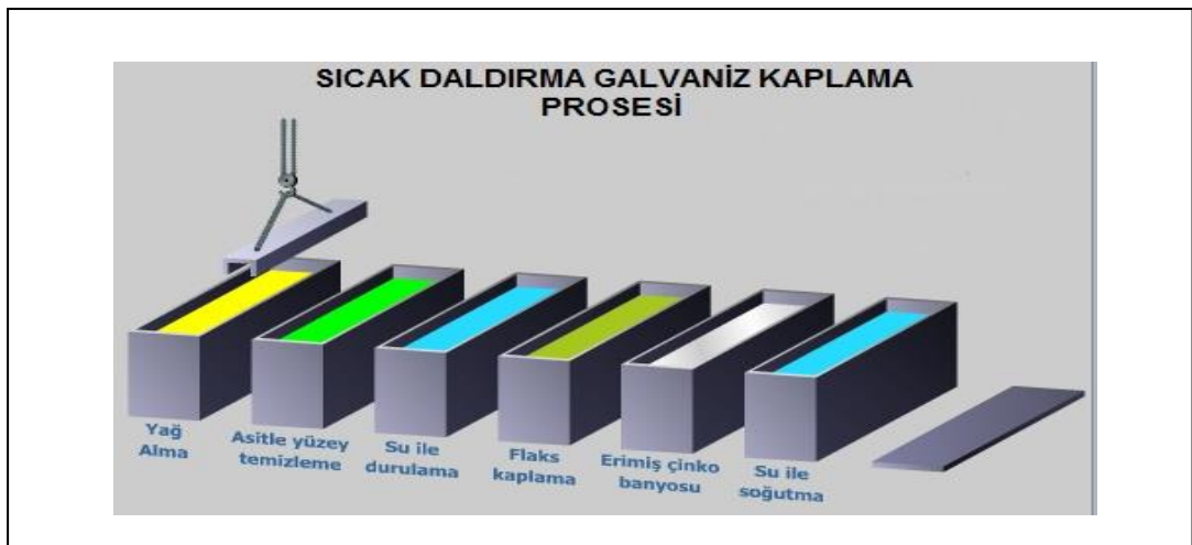
Şekil 2.3: Sıcak Daldırma İle Yapılan Galvanizleme İşlemi
