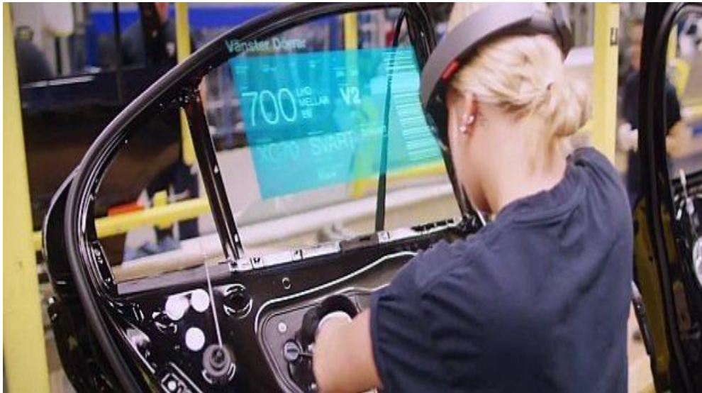
Şekil 2.20: Volvo'nun kullandığı HoloLens Sistemi
