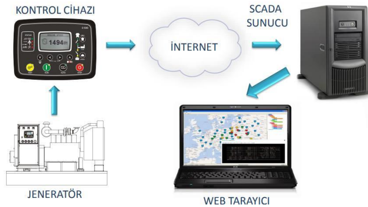
Şekil 5.1: Dizel jeneratör seti SCADA sistemi
