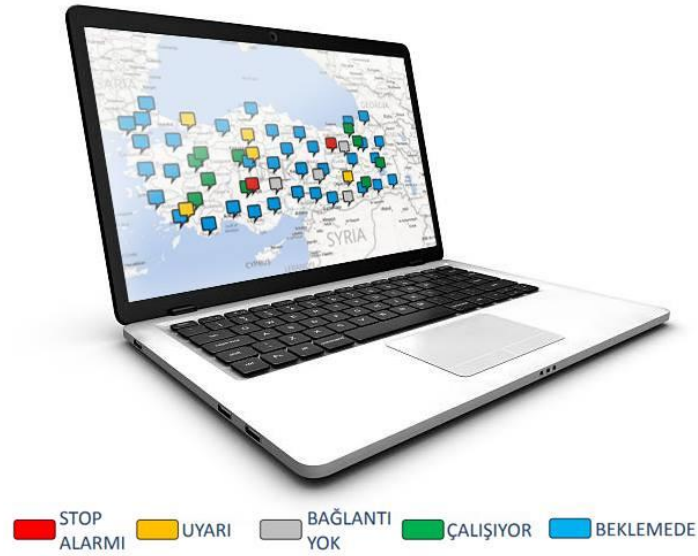
Şekil 5.2: SCADA sistemi izleme görseli
