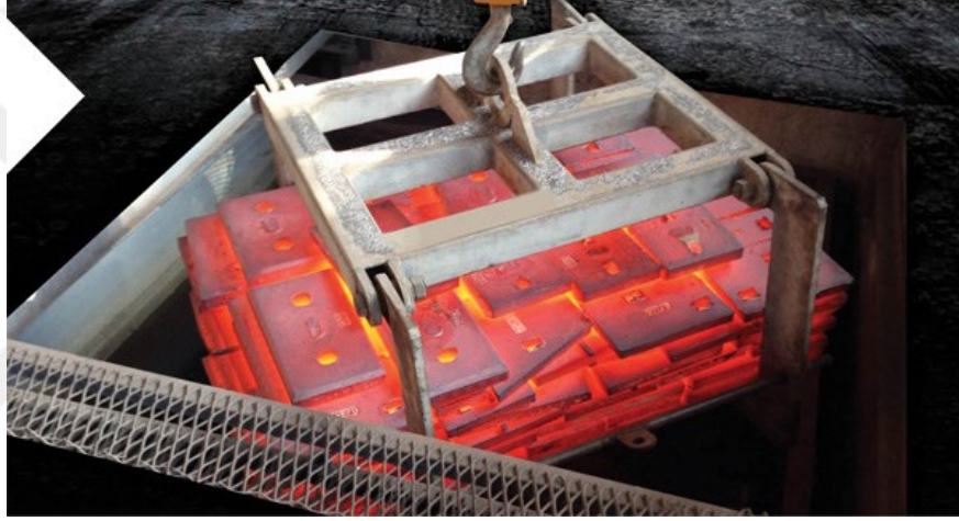
Şekil 3.6: Isıl İşlem Fırınından Çıkan Malzemeler
