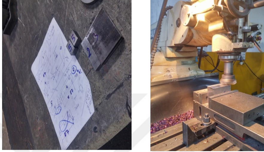
Şekil 3.2: Çekirdek Kalıbın Malzemeleri Ve Frezeleme İşlemi
