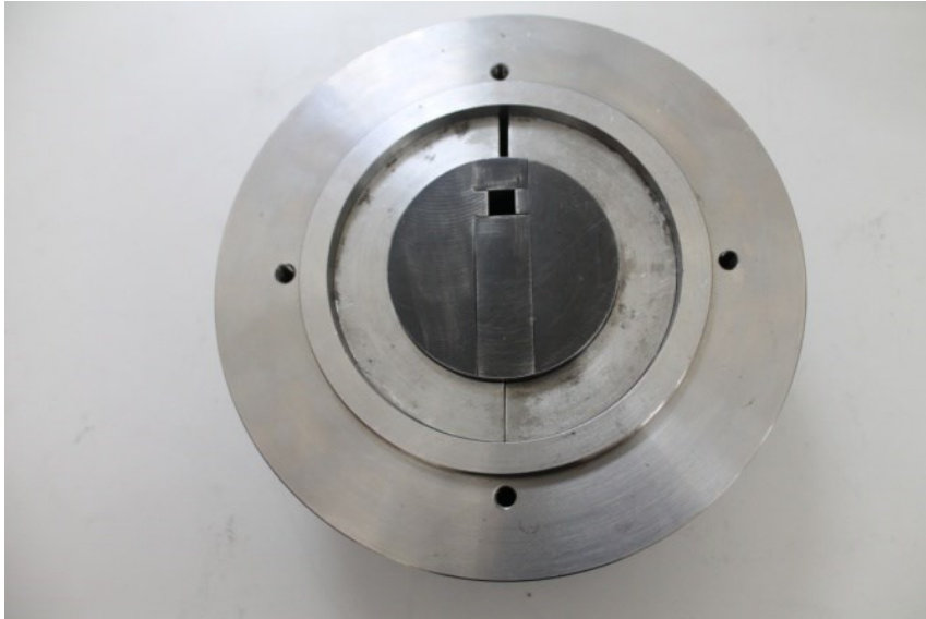
Őekil 3.12: ekirdek Kalıp Sıkma Aparatı ve Dıř Kalıbın Birleřmiř Hali
