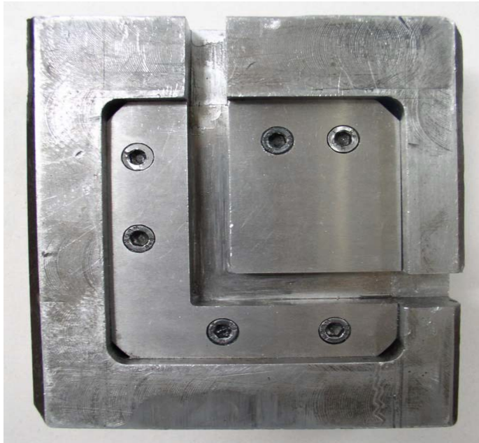
Şekil 1.7: Aşırı Plastik Deformasyon Kalıbı Fotoğrafi (Açık durum) [47]
