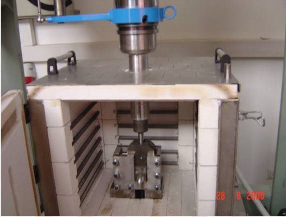
Şekil 1.4: EKAP Kalıbı Fırın İçine Yerleştirilirken [44]
