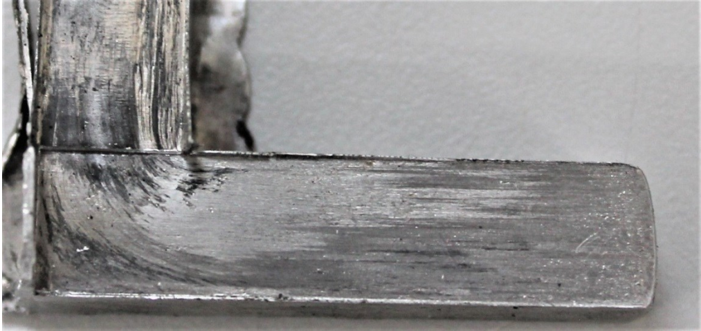
Şekil 2.12: EKAP Kalıptan Birinci Pasodan Sonra Malzemenin Görünümü
