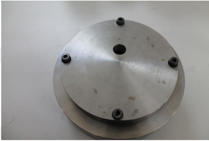
Şekil 3.14: Üst Kapağın Dış Kalıba Bağlanması
