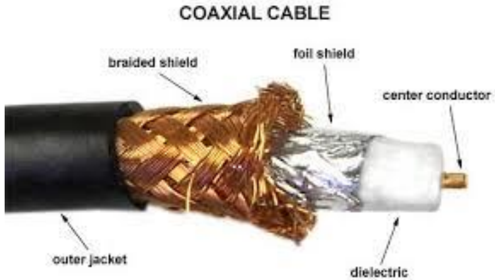
Şekil 6. 1 Koaksiyel kablonun yapısı
