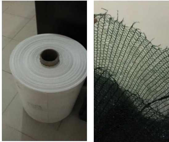
Şekil 3.75 _Kibaa eko kubbede kullanılan sarmal torbalama ve madeni ağ (studio, 2015)
