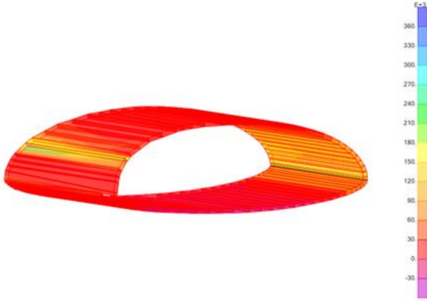
Şekil A.6 Beton kabuk çatının kesme gerilimi (teğetsel gerilim) diyagramı (kN/m 2 cinsinden) (Dezeen magazine, 2009)
