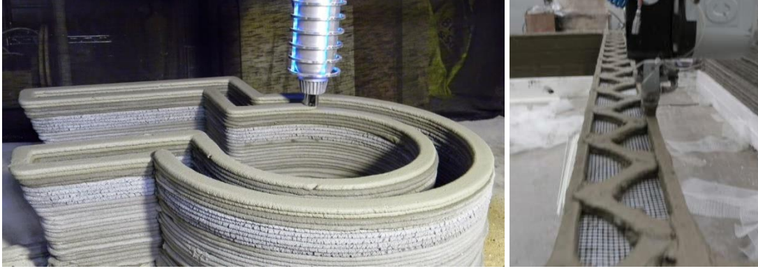
Şekil 4.4 Kontur İşleme yazım sistemi (URL, 23)
