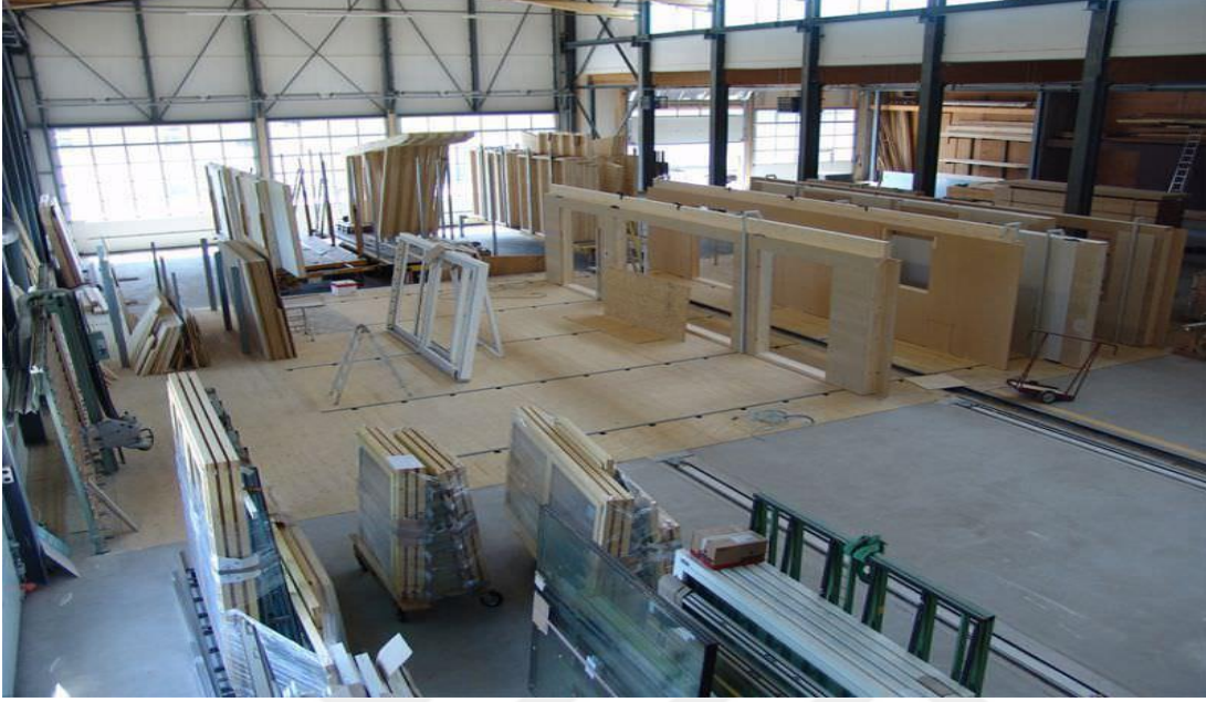
Şekil 3.29 Barınak parçalarının fabrikada üretilmesi (URL, 17)
