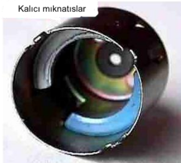
Şekil 2.6: BDC motorun statorunda kalıcı mıknatıslar [33].
