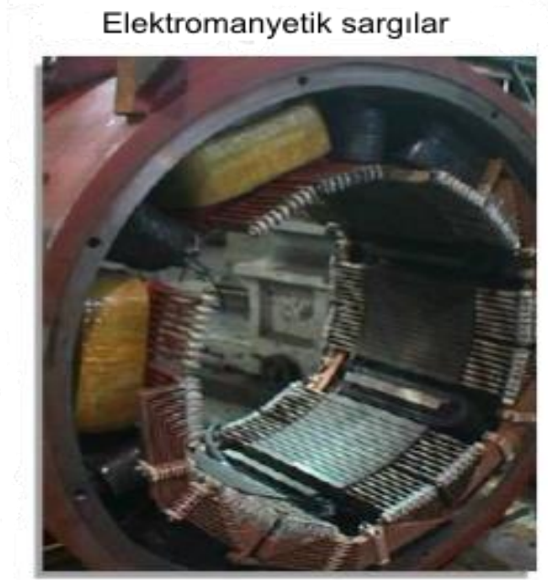
Şekil 2.5: BDC motorun statorunda elektromanyetik sargılar [28].
