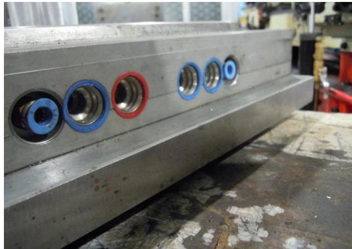
Şekil 9. Soğuk ve sıcak su giriş bölgeleri gösterimi
