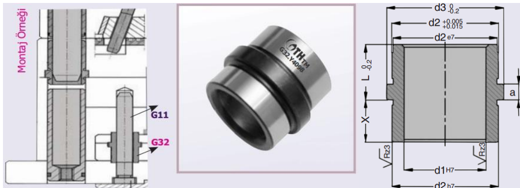
Şekil 27. Standart elemanlar \ Ortadan şablonlu burç
