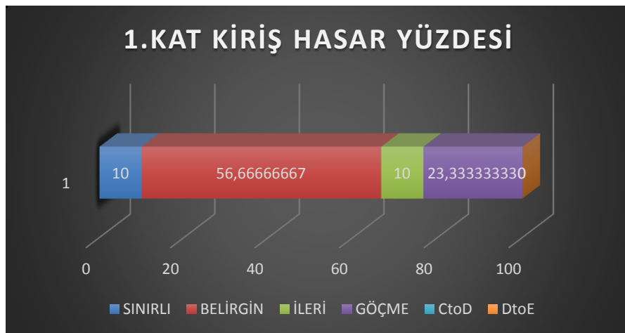
Şekil 4.5: 4 Katlı Yapıya Ait 1. Kat Kiriş Hasarı
