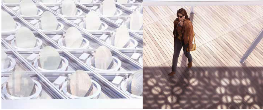
Şekil 63. Carlo Ratti'nin Sun & Shade Kanopisi, Güneş Enerjisi Toplamayı Optimize Etmek İçin Ayarlanabilir Aynalar Kullanır Gölge Sağlarken. Kanopi, Aşağıdaki Gölgede Kelimeleri ve Tasarımları Heceleyerek Sanatsal Bir Görüntü Oluşturur
