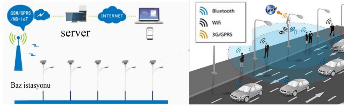
Şekil 20. Akıllı Aydınlatma Kontrol Şeması
