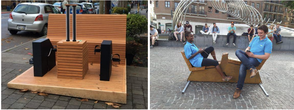
Şekil 62. Sol: Victoria'nın İlk Şarj İstasyonu Cook St. Village'da Bisikletle Çalıştırılıyor. Sağ: Havaalanı Şarj İstasyonu, Enerji Üreten Mobilyalar Enerji Üreten Egzersiz Ekipmanı, Cep Telefonlarına veya Diğer Cihazlara Güç Sağlamak İçin Elektrik Üretme Konusunda Kullanıcılardan Kaynaklanan Sürtünme
