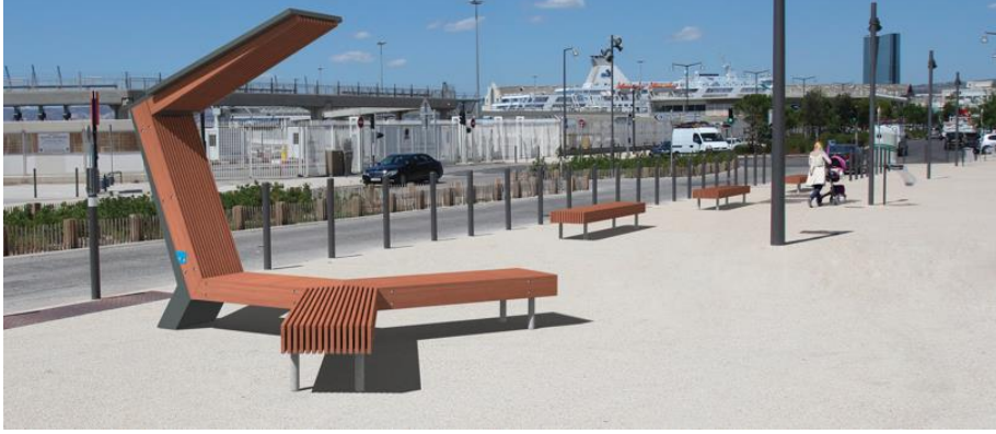
Şekil 57. Çekici Bir Şekilde Tasarlanmış Yan Çerçeve, Bankın Yanlarındaki Şarj Noktaları İçin Bir Enerji Kaynağı Olan Bir Fotovoltaik Panel veya Bir Wi-Fi Sinyal Vericisi Taşır. Panel, Güneşe Göre En Uygun Konuma Döndürülebilir
