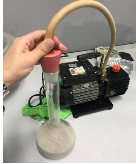
Şekil 4.7: Numunenin Hava Kabarcıklarından Arındırılması İçin Vakumlanması
