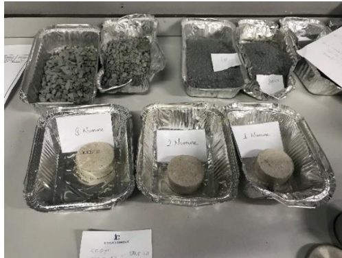
Şekil 4.35: Konsolidasyon deney sonucu etülden çıkan numuneler
