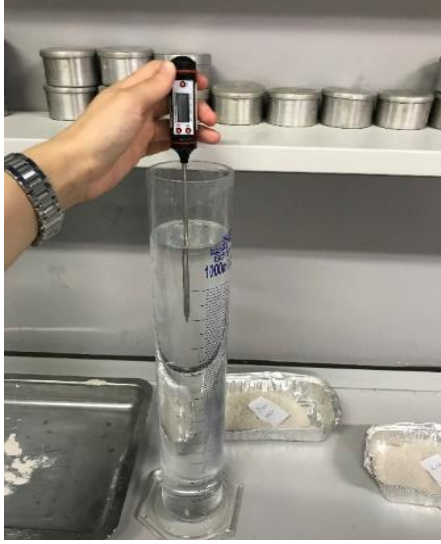
Şekil 4.6: Su Sıcaklığının Ölçülmesi
