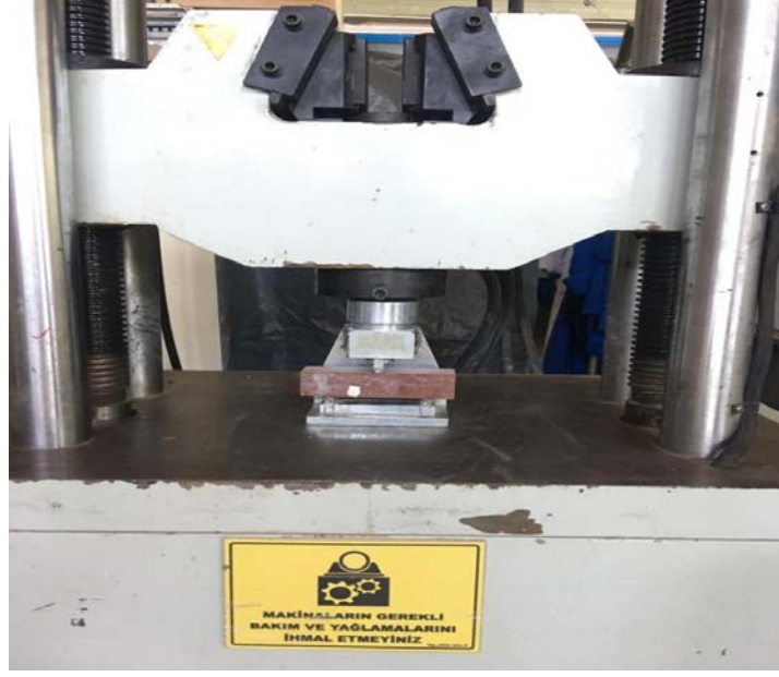
Şekil 4.2: Eğilme dayanımı testinin prizma numulere uygulanması
