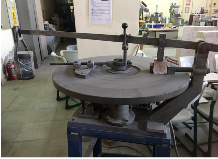
Şekil 4.6: Böhme aşındırma aleti
