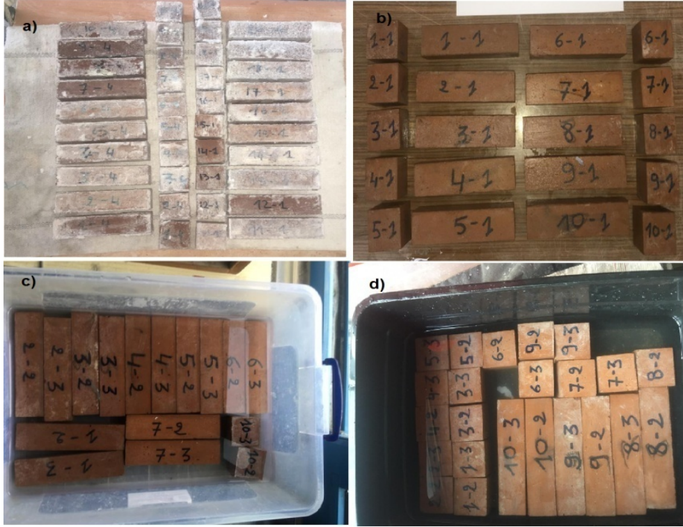
Şekil 5.44: (MgSO 4 ) maruz kaldıktan sonra numuneler , b) (Na 2 SO 4 ) maruz kaldıktan sonra numuneler c) (MgSO 4 ) maruz kaldıktan sonra numuneler, d) (Na 2 SO 4 ) maruz kaldıktan sonra numuneler
