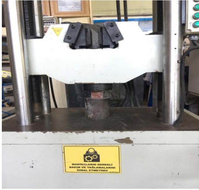
Şekil 4.1: Basınç dayanımı testinin küp numunelerde uygulanması
