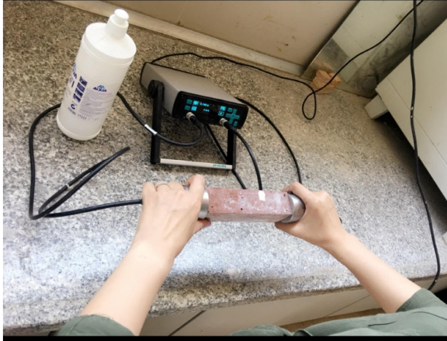
Şekil 5.41: Ultrases Geçiş Hızı testi
