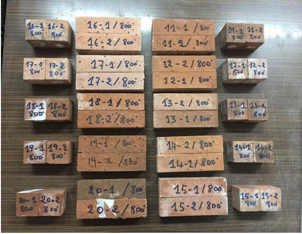
Şekil 5.25: 800 °C den sonra yüksek sıcaklığa maruz kalan numuneler
