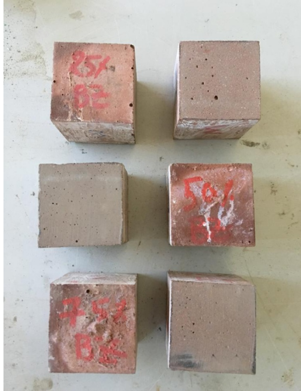
Şekil 5.10: Aşınma testinden sonra incelenen numuneler.
