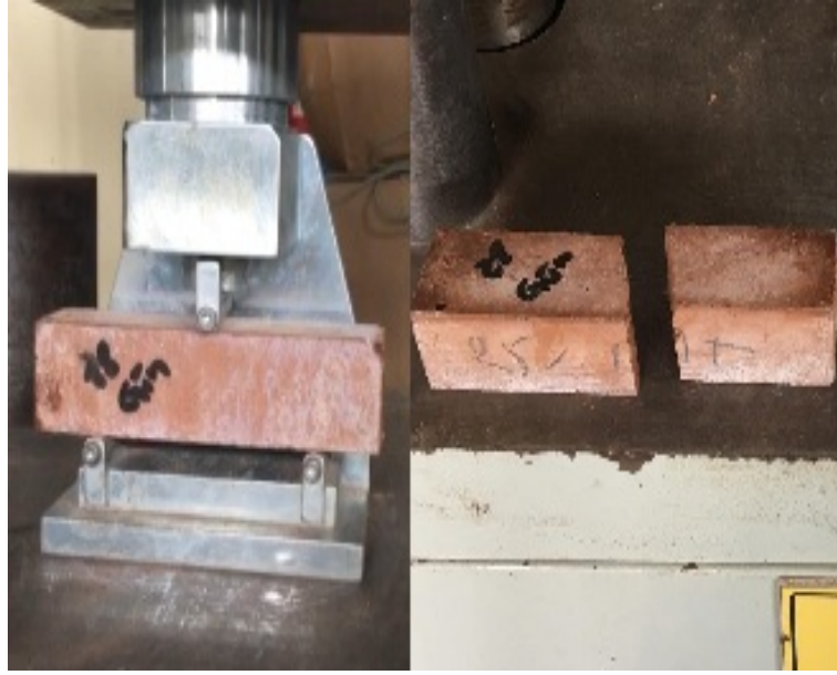
Şekil 5.5: Harç numunelerin eğilme dayanımı testi
