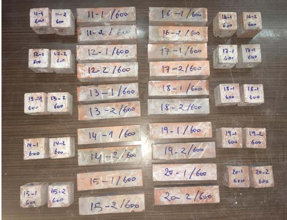
Şekil 5.24: 600 °C den sonra yüksek sıcaklığa maruz kalan numuneler
