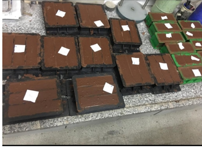
Şekil 4.17: 50 x 50 x 50 mm küp ve 40 x 40 x 160 mm prizma kalıplar
