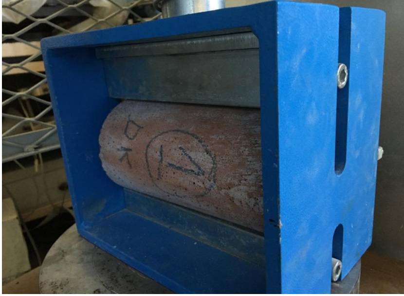
Şekil 4.3: Yarma çekme dayanımı testinin silindir numulere uygulanması
