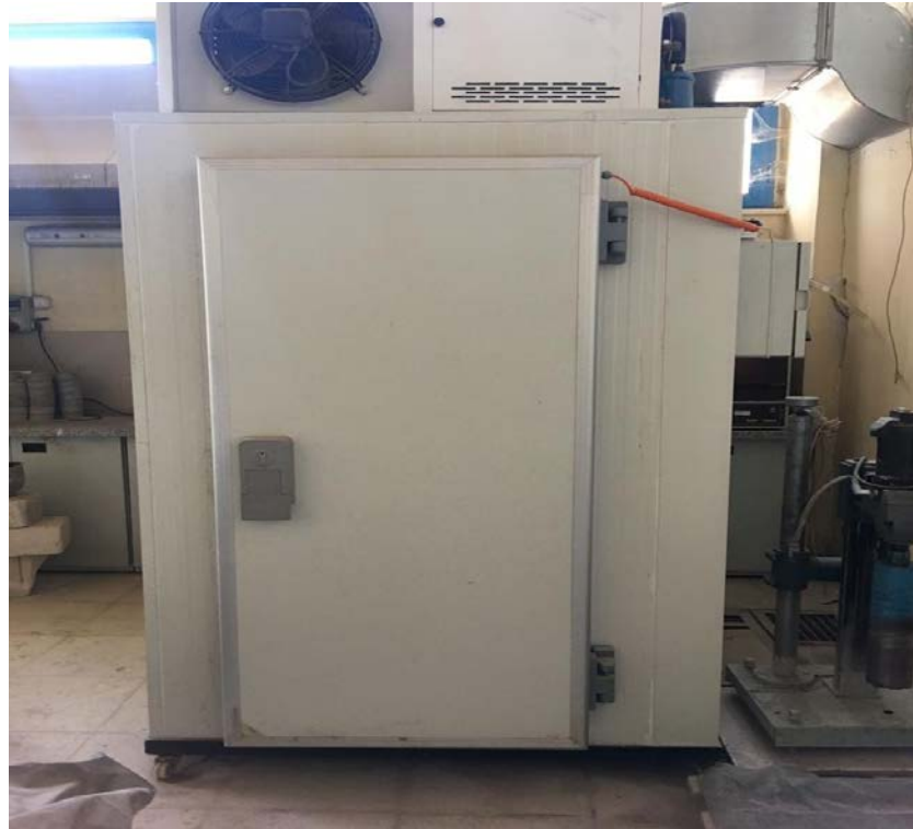
Şekil 4.11: Donma çözülme cihazı
