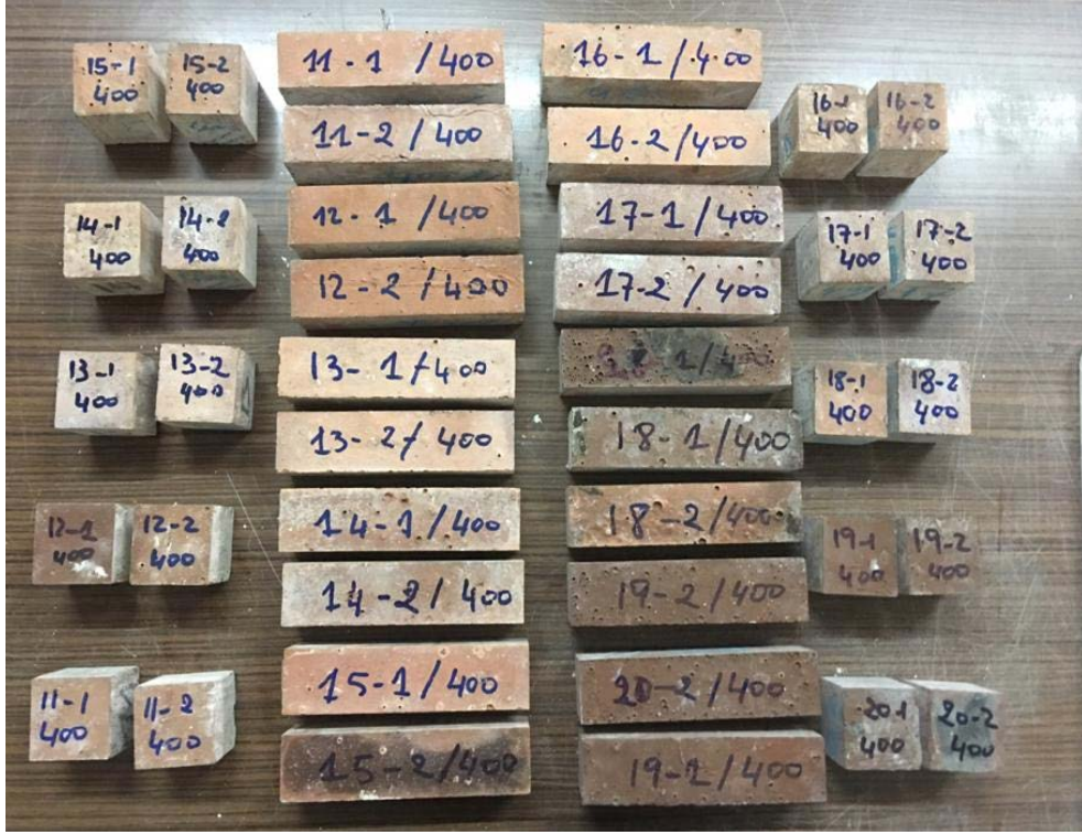
Şekil 5.23: 400 °C den sonra yüksek sıcaklığa maruz kalan numuneler
