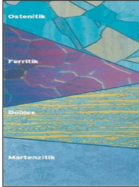
Şekil 2. Paslanmaz çelik türlerine ait mikro yapı görüntüleri
