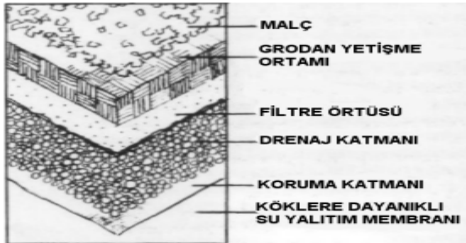
Şekil 3.22: Grodan İle Oluşturulan Bir Çatı Bahçesi Detayı
