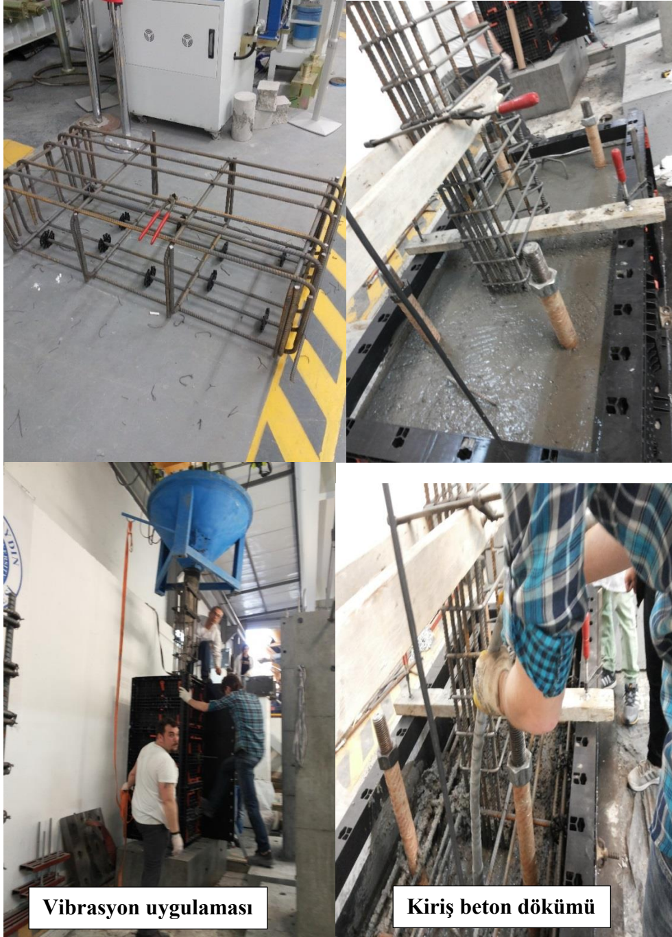
Şekil 2.3: KY01-3.6 Numunesinin İmalat Aşamalarına Ait Fotoğraflar
