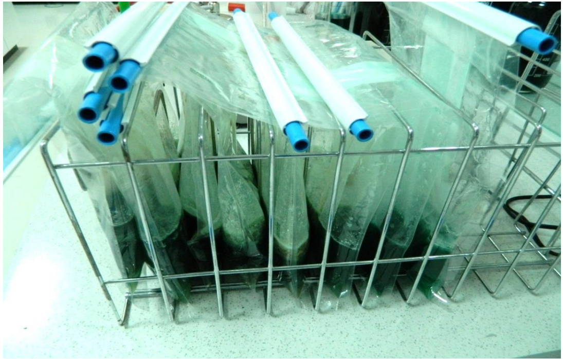
Şekil 3.3. Stomacher cihazında filtreli torba içerisinde süspansiyon edilmiş kırmızı et numunelerinin inkübasyona hazır hali
