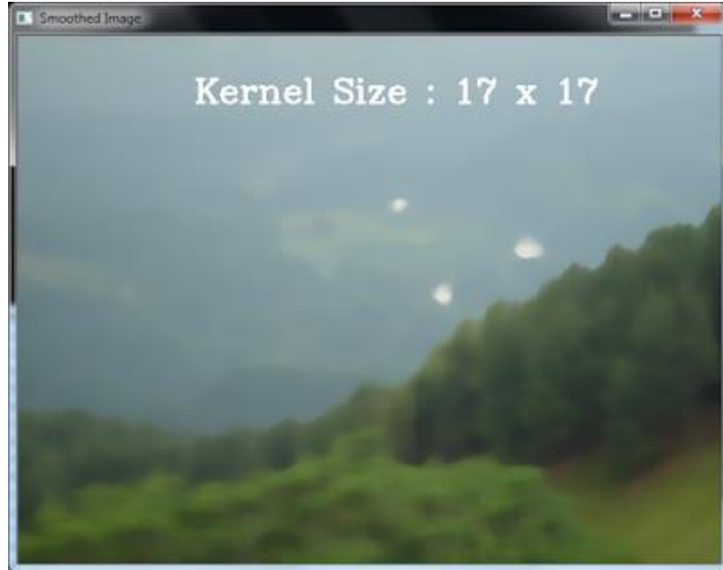
Şekil 3.9 Smooth Median Uygulanmış
