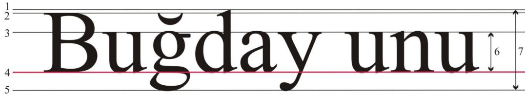
Şekil 2.2 x-yüksekliğinin tanımı. 1: Üst çıkıntı hizalama çizgisi, 2: Tepe çizgisi, 3: Orta çizgi, 4: Satır çizgisi, 5: Alt çıkıntı hizalama çizgisi, 6: x-yüksekliği, 7: Punto büyüklüğünü göstermektedir
