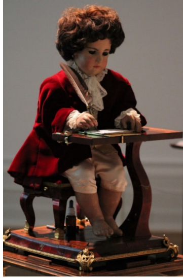
Şekil 12. Jaquet Droz'un 1770-1772 yıllarında geliştirdiği yazı yazabilen otomat, (ablogtowatch.com, 2023).
