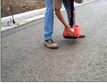
Şekil 14 Yol kesitinde yoğunluk ölçümünde kullanılan nükleer cihaz (Harrington vd., 2010:71)
