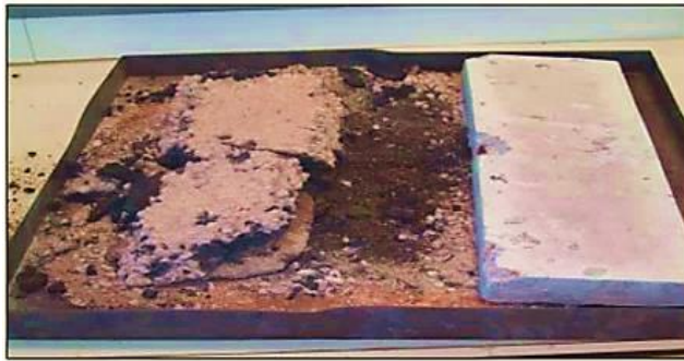
Şekil 15 Asfalt (solda) ve betonun (sağda) 750 °C sıcaklıkta karşılaştırılması
