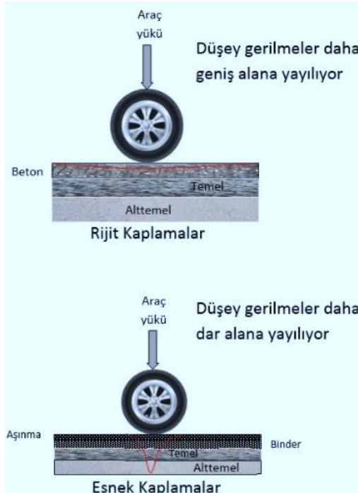
Şekil 4 Esnek ve Rijit kaplamada oluşan gerilmeler
