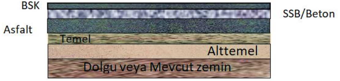
Şekil 29 Kompozit kaplama ( Asfalt üstü SSB ve bsk )
