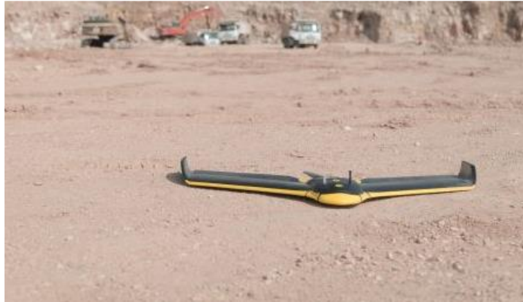
Şekil 34 Şantiye Haritası Çıkarmak Amacıyla Kullanılan Bir Dron (Can, 2021: 33)
