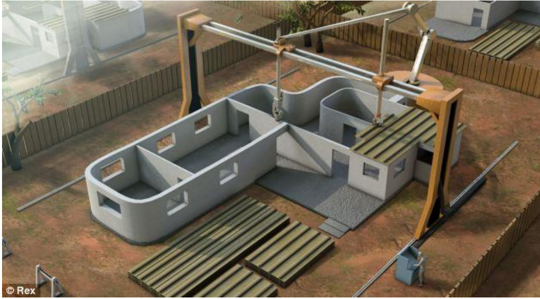
Şekil 26 3B Yazıcı ile Yapı Üretimi (Dailymail.co.uk, 2014)
